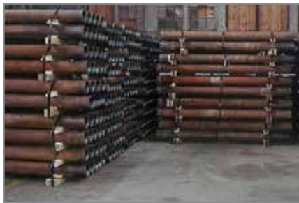
Micropilotes hembra y macho cortados y empaquetados según especificaciones.
